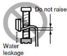
Nieprawidłowy montaż węży kondensatu
