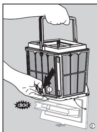
8.1.4 W celu usunięcia zanieczyszczeń - otwórz dolną pokrywę kosza używając zatrzasku pokrywy.
